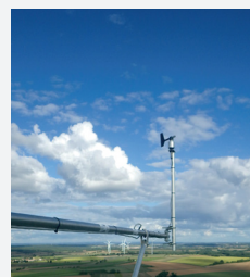
Girouette Mesure les directions du vent
