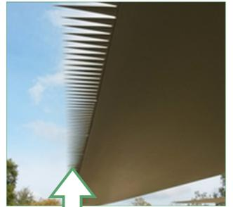
Des dentelures sont installées sur le bord de fuite des pales. En réduisant les turbulences, le bruit est réduit de 2 à 3 dB.
