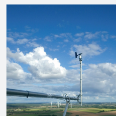
Girouette Mesure les directions du vent
