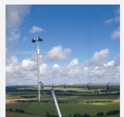
Anémomètre Mesure la vitesse et la pression du vent
