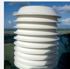
Sonde de température Transforme l'effet du réchauffement ou du refroidissement en signal électrique
