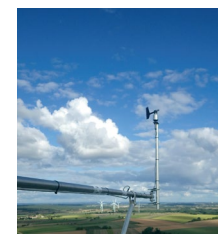
Girouette Mesure les directions du vent
