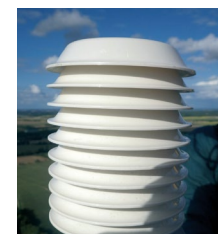
Sonde de température Transforme l'effet du réchauffement ou du refroidissement en signal électrique
